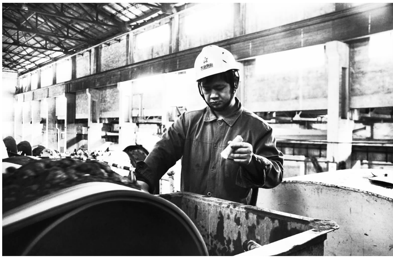
▲这是该磨浮生产班职工在球磨机进料漏斗前观察底部衬板情况。方圆 摄
