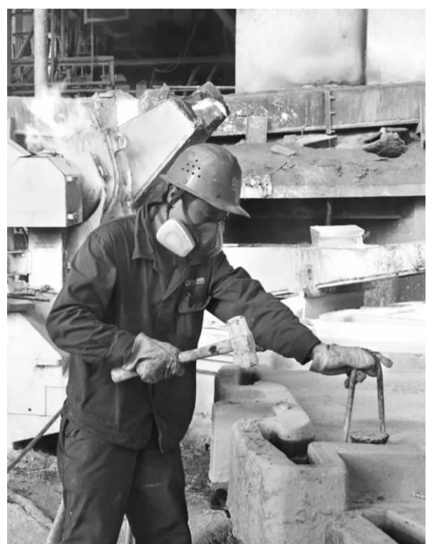
▲左图是顶针被铜渣堵住,职工正在捶打顶针,使其自由落下。使用单孔顶针设计后,职工的劳动量减少了许多。右图是在双圆盘浇铸现场,单孔阳极板上的顶针顶起阳极板,捞板机顺利地捞起阳极板“抱住”,准备放入水中冷却。黄琨摄
