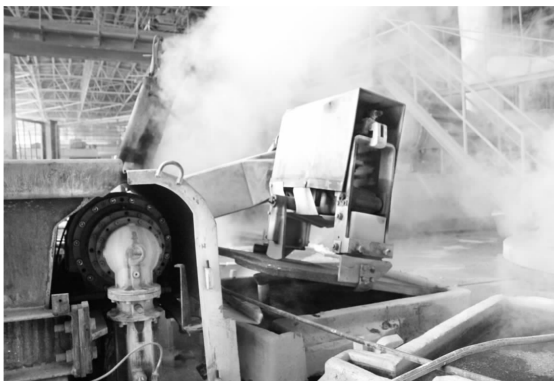
▲左图是顶针被铜渣堵住,职工正在捶打顶针,使其自由落下。使用单孔顶针设计后,职工的劳动量减少了许多。右图是在双圆盘浇铸现场,单孔阳极板上的顶针顶起阳极板,捞板机顺利地捞起阳极板“抱住”,准备放入水中冷却。黄琨摄
