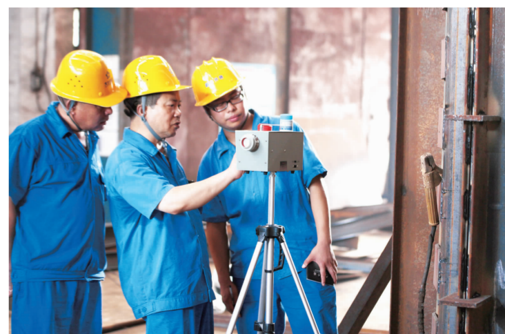
▲江苏昆山中荣金属制品厂“8·2”爆炸事故引起了鑫力井巷公司的高度重视。连日来,该公司加强机修车间各金属加工点的金属粉尘检测力度,避免同样的悲剧不再重演。这是该公司安全人员在检测车间厂房内的金属粉尘浓度时的情景。郭小勇 摄
