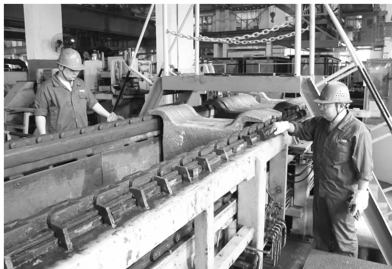
▲殷广顺(右一)与班组职工认真检查阳极钎耳机,仔细清理机身油污,以保证设备顺畅运转。 魏马亮 摄
