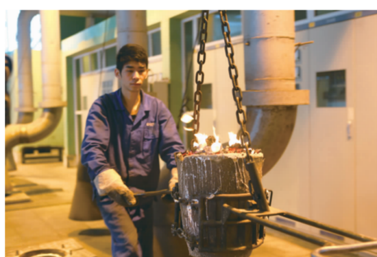
▲5月1日,稀贵厂精炼车间浇铸班职工正在进行浇铸作业。晴川 摄
