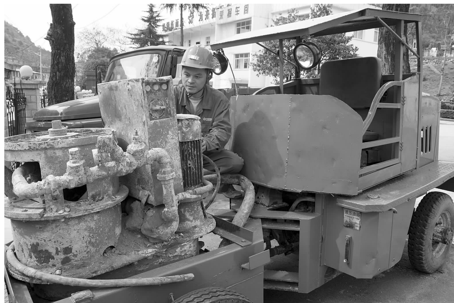
▲图为采掘车间技术人员对车载式移动喷浆机进行完善。倪罗斯 摄
