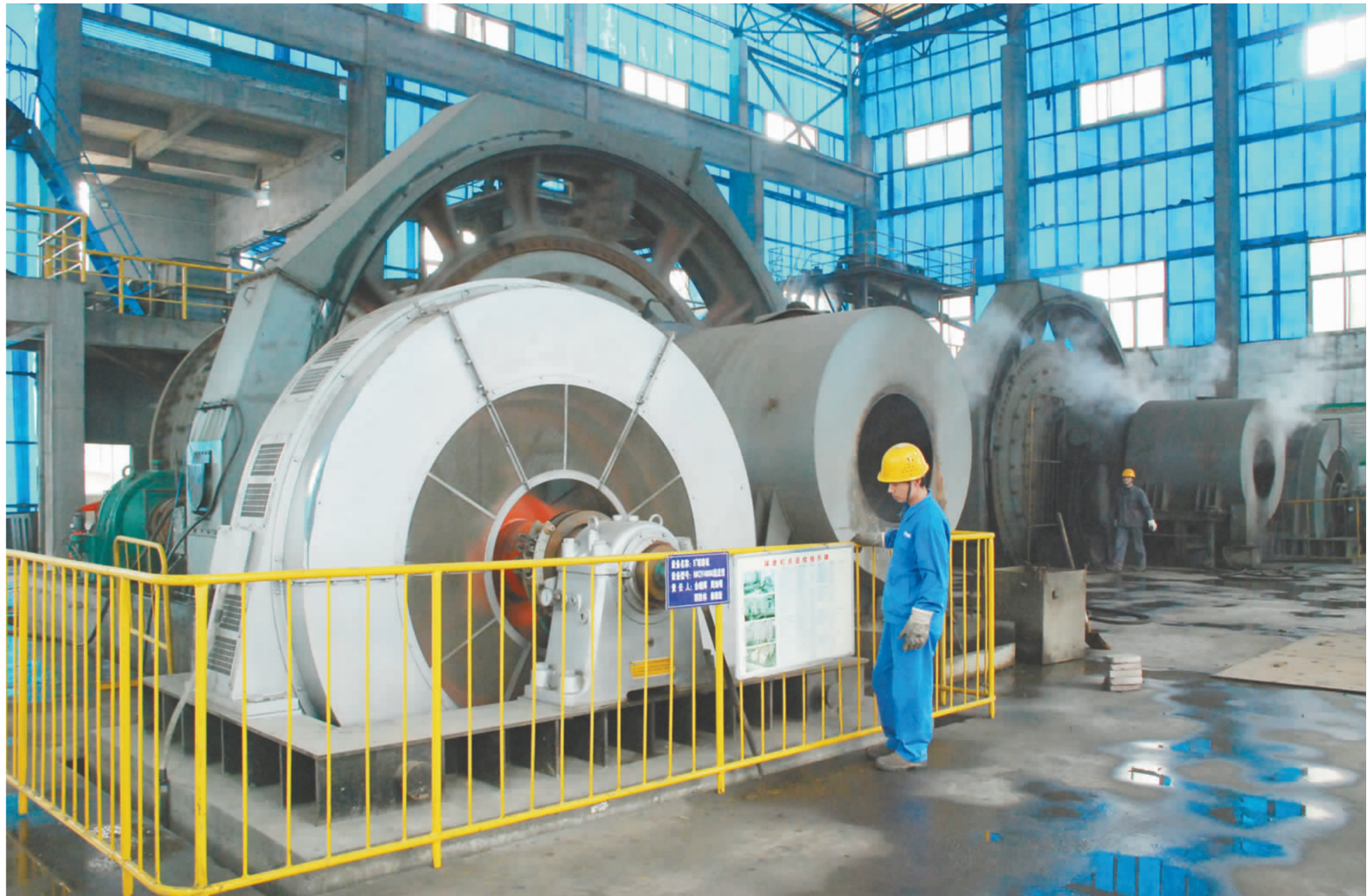
▲目前大冶有色最大的磨矿设备—MQY4060球磨机
