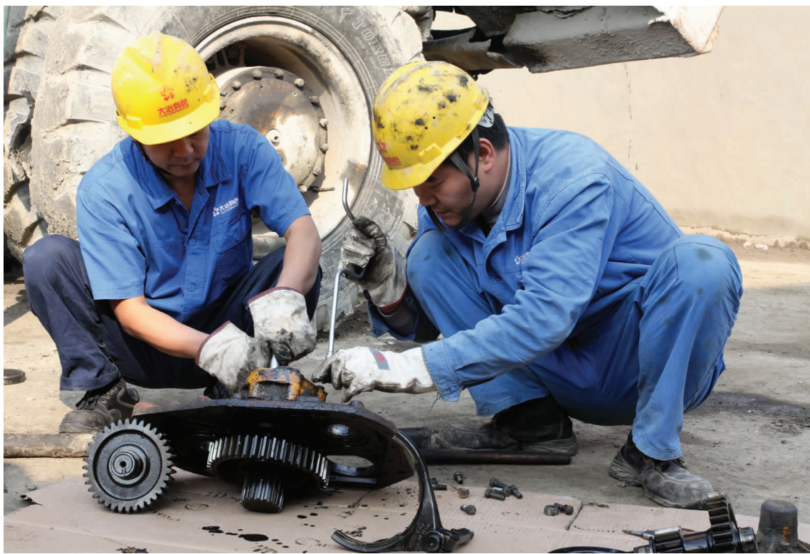
▲维修二工段维修工正在拆卸法士特变速箱。汪纯 摄
