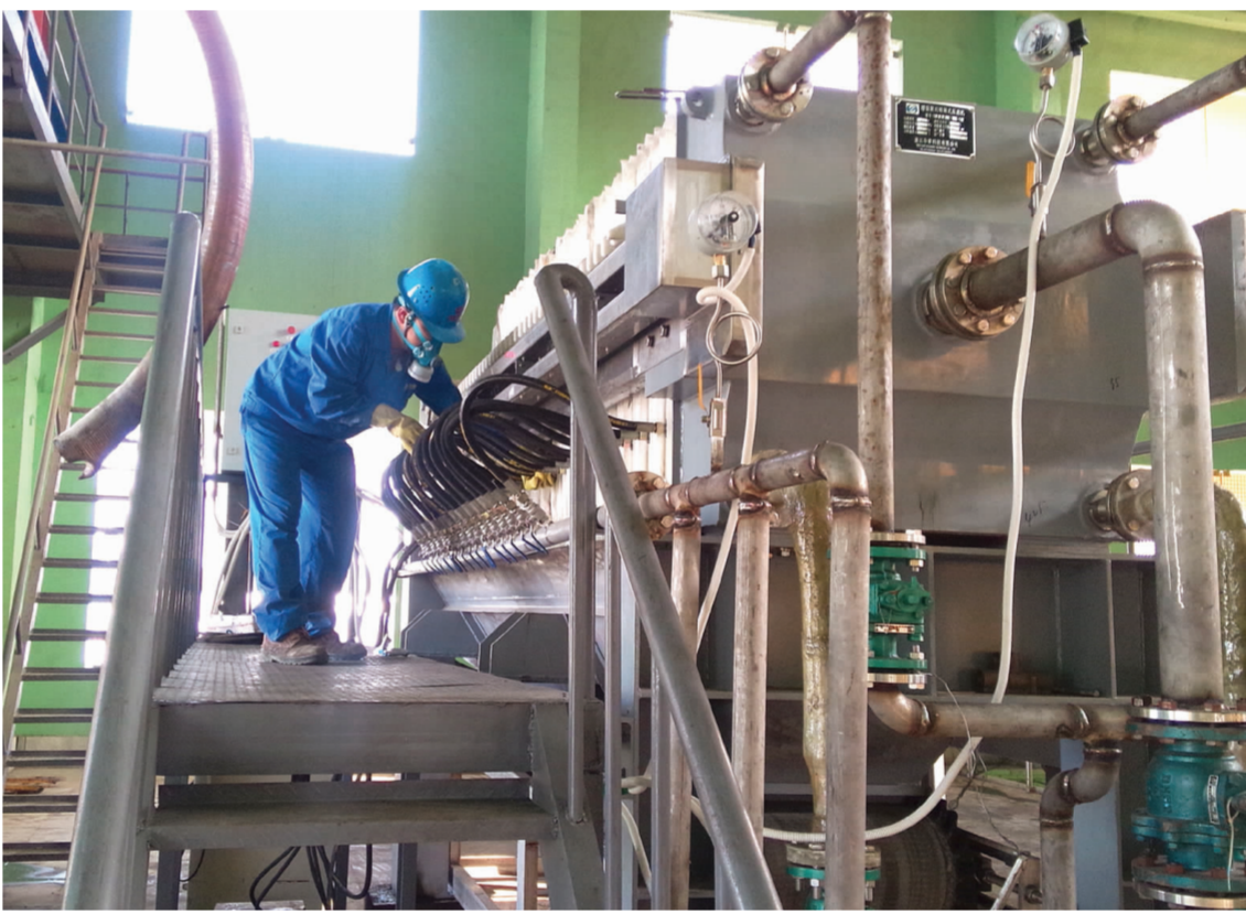
▲粗炼班职工正在检查板框压滤机运行情况 高功江 摄
