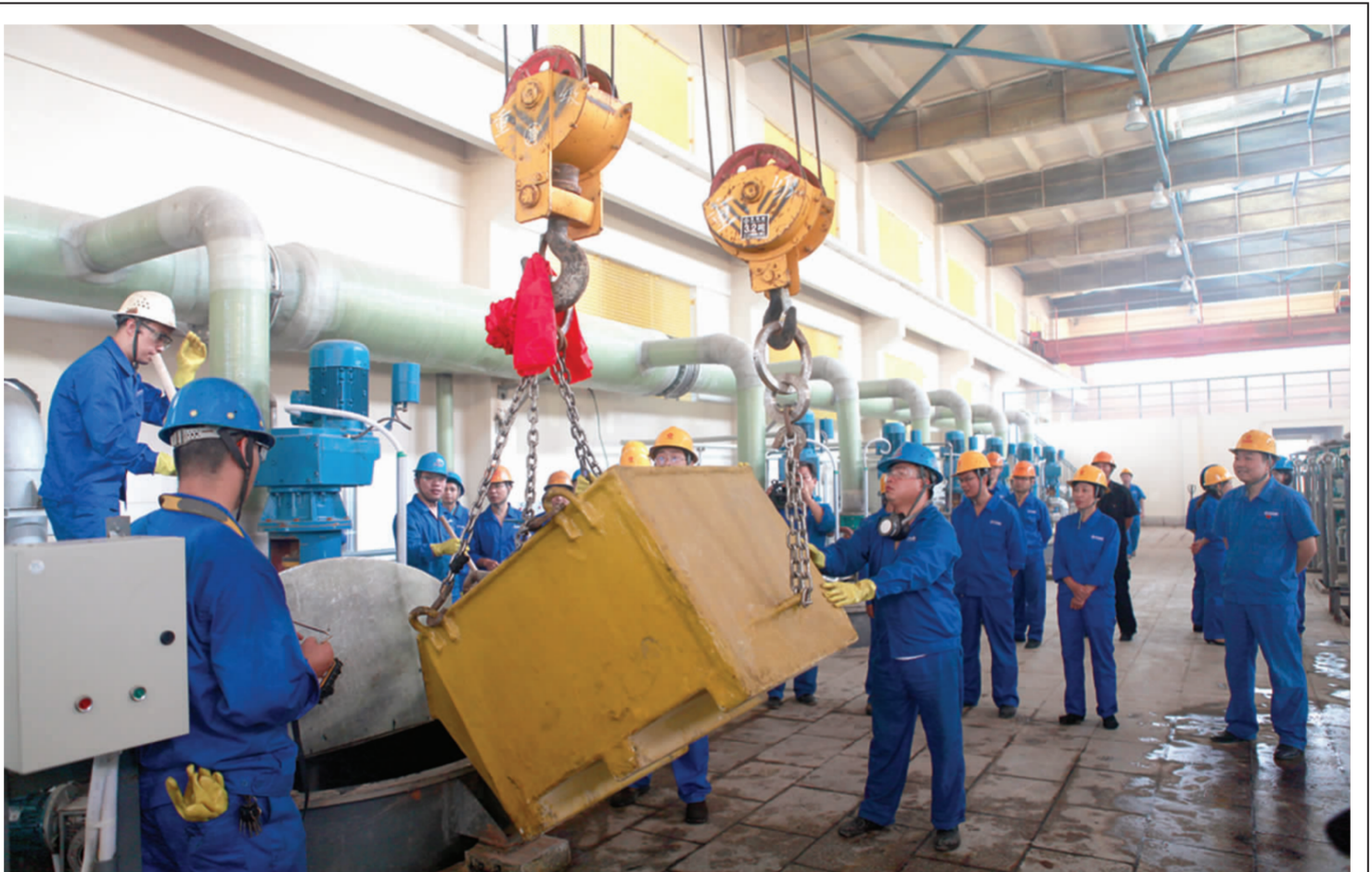
▲ 碎精制项目现场，操作人员按照项目负责人指令，向反应釜中加注第一批碎精矿。 晴川摄
