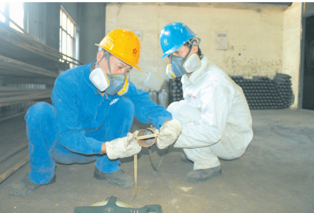
▲图为该车间职工正在测量堵枪枪头尺寸。刘欣杰 摄
