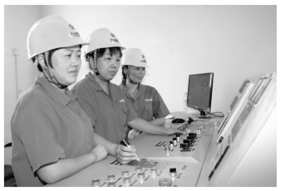
▲铜山口矿深部开采基建工程之一的副井设备安装已全部到位,正在抓紧设备调试工作。图为8月21日,卷扬机操作女工在控制台前进行调试操作。 董言 摄
