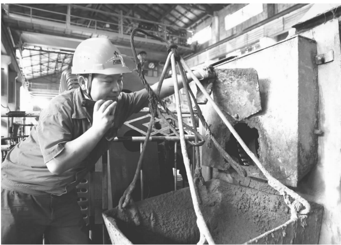
▲图为磨浮工段球磨工正在通过圆筒筛观察球磨机内运作情况。 张琳 摄
