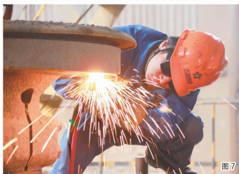
图1 稀贵金属厂职工清理储槽内沉积的污酸渣。 图2 丰山铜矿水电车间外线电工高空作业,为矿区的夜晚带来光明。 图3 铜山口矿化验室女工在精确称量化验药品,以准确获取矿石品位数据。 图4 冶炼厂熔炼车间职工在精心检查电机运转情况。 图5 建安机电公司焊工展现高超技艺,在对圆盘气管进行焊接。 图6 铜绿山矿外线电工正在高空安装横担,为架线作准备。 图7 铜绿山矿选矿车间机电工投焊工对圆锥破碎机进行检修。 图8 铜山口矿球磨维修工正在奋力抢修球磨机。
