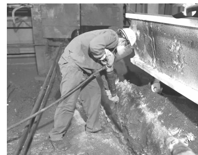
▲8月份以来持续高温,冶炼厂职工仍坚守岗位,为完成产量任务而奋力拼搏。图为8月24日,澳炉职工顶着炎热高温在清理溜槽。张勇摄
