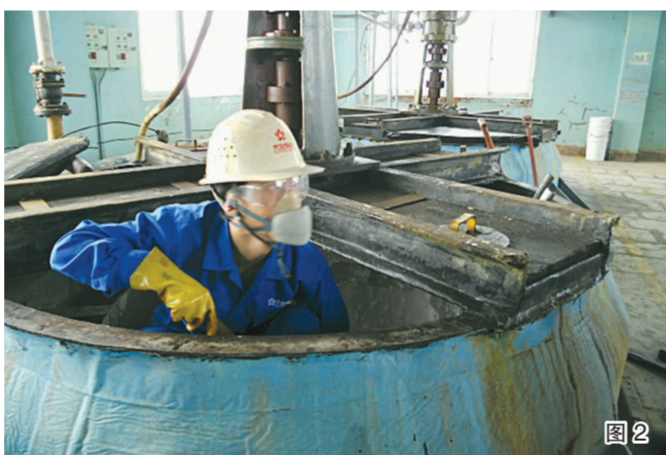
图2 稀贵厂硫酸镍车间制冷班副班长李智强,在厂、车间和班组“急难险重”的任务面前一马当先,进入制冷结晶罐进行罐体结晶的清理工作。张振波 摄
