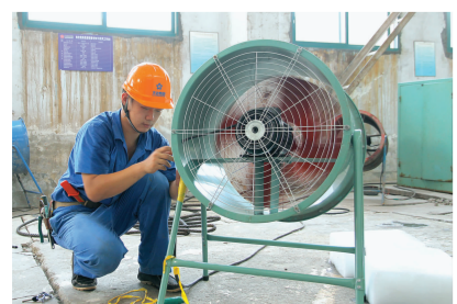
▲8月1日,铜绿山矿机运车间用鼓风机和冰块合成“设备空调”,为设备降温,确保安全生产。 陶坤 摄
