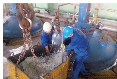
▲8月以来,稀贵厂积极完善工业园设备设施,力保主产品各项工艺指标及产量任务完成。图为粗钎车间职工冒酷暑,往沉银反应釜内加氧化镍。 郭雁 摄
