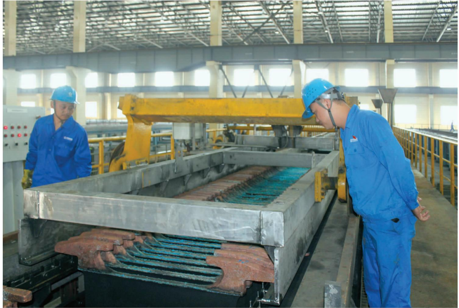
▲7月16日，阳极机组班的职工正在检查残极洗涤剂组受板架上的残极厚薄情况，确保残极顺利进入洗涤室。 刘欣杰 摄
