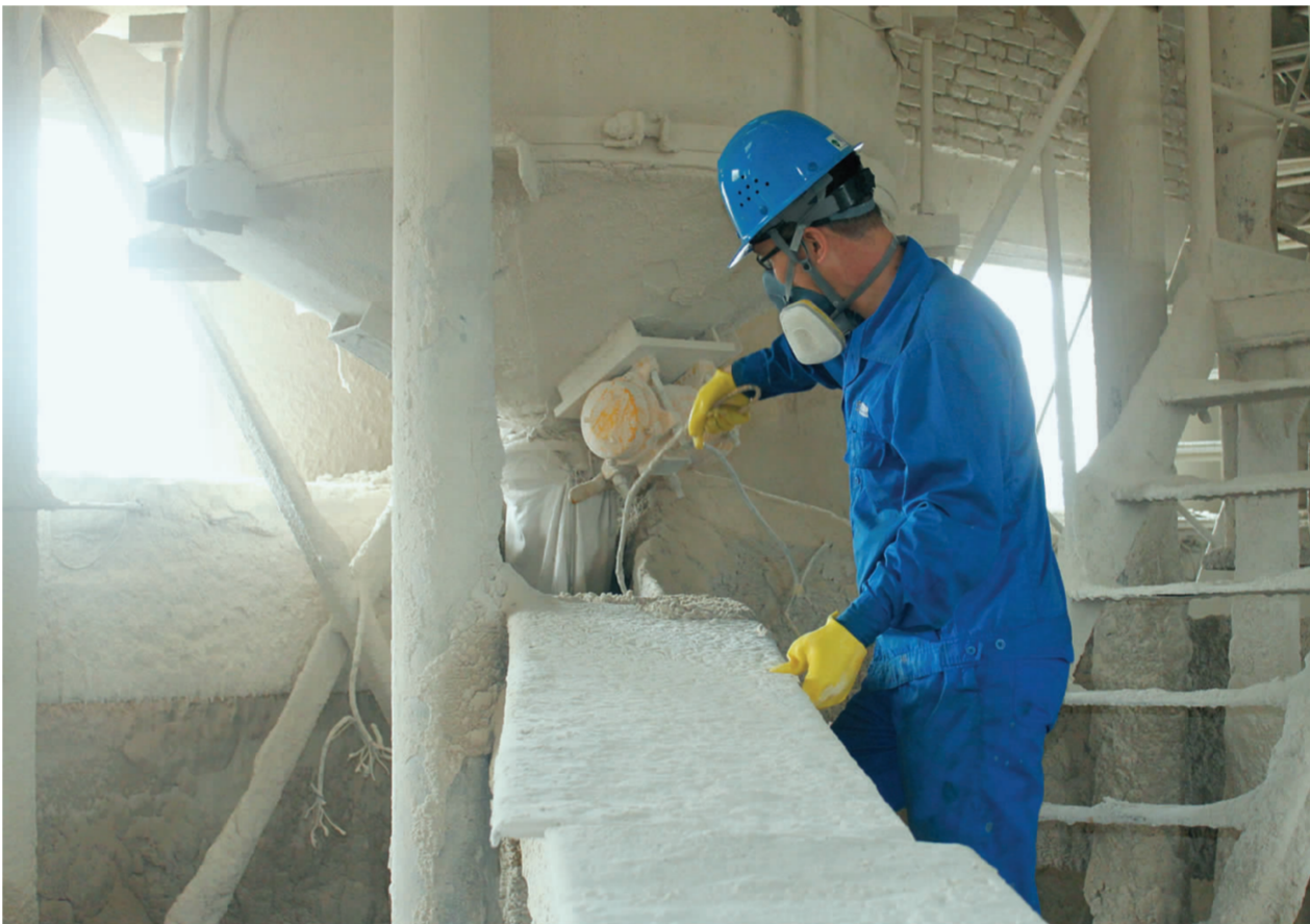
▲ 图为该车间职工在下料槽前改造石灰乳,避免凝固粘堵。 黄红梅 摄
