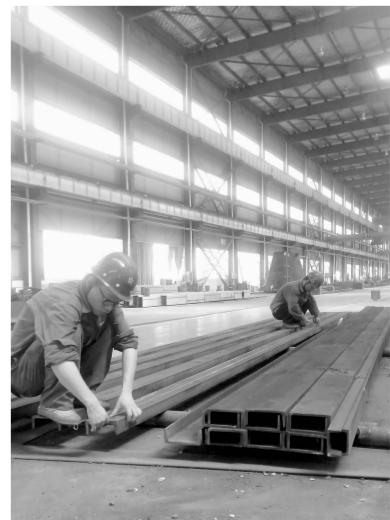
▲为进一步提高产品质量,建安金格钢构公司积极开展“我的操作最标准,我的技术最过硬,我的质量无异议”的“优良产品”生产示范岗活动。因为6月28日,铆工正在对槽钢进行精准放样。(乐安带 摄)
