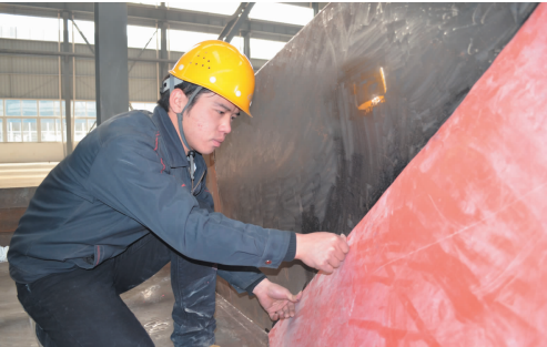
元旦 1 日,鑫鹰环保有限公司职工正在对叠层高频振动筛收集斗进行胶皮粘贴。(陈丁 摄)
