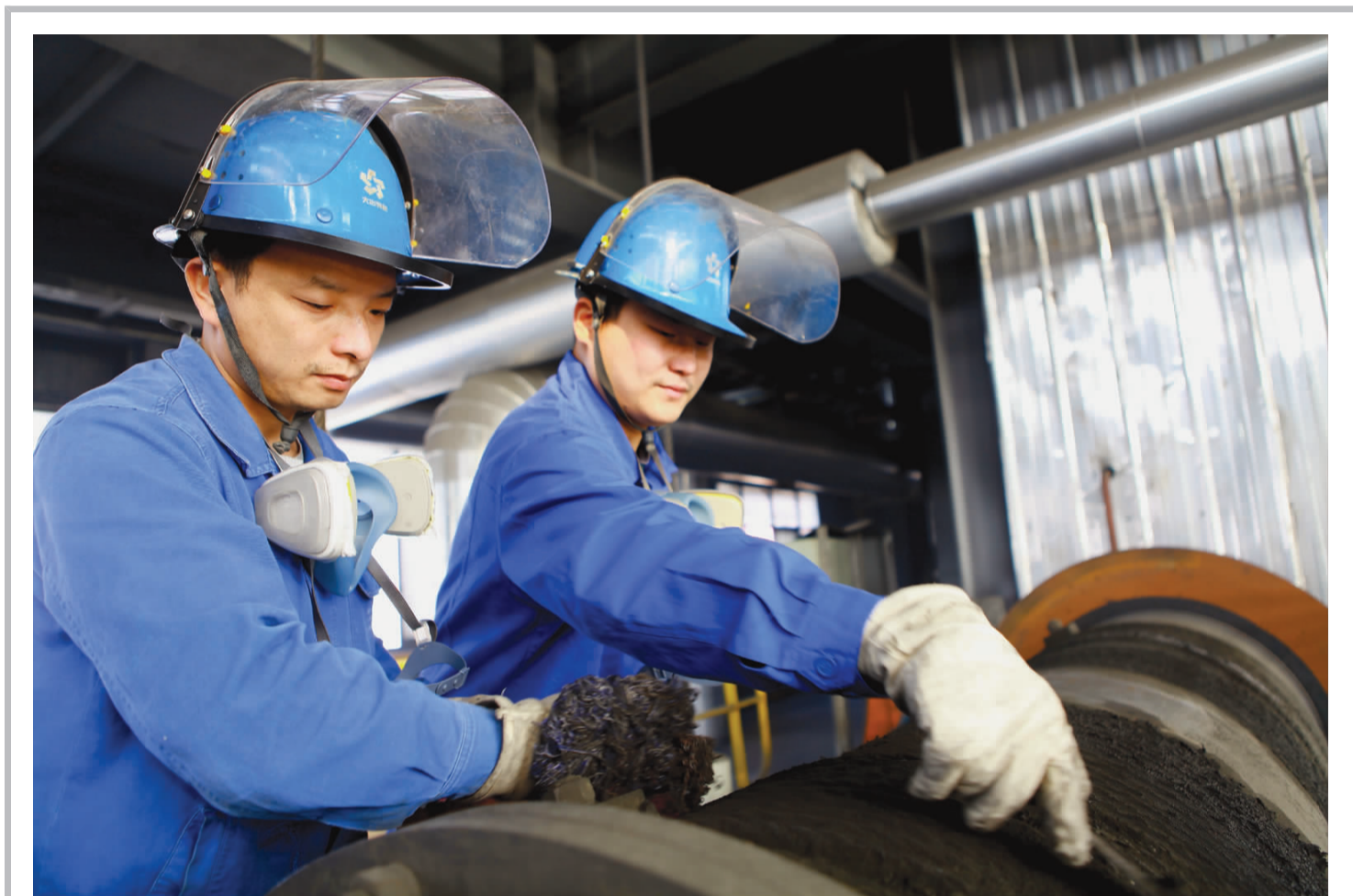
冶炼厂在推进TPM管理工作过程中,将点检、润滑、清扫等工作规范化、系统化到TPM管理相关活动中,并创新了以状态保养和预知维修为主的设备检修模式,有效延长了设备的使用寿命,保证了设备安全平稳运行,使设备可开动率始终保持在98%以上。图为11月6日,该厂职工对澳炉喷枪卷扬进行维护保养。(刘飞摄)
