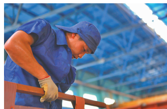
在冶炼厂电解二车间的槽面上,职工正在电解槽上进行阴阳极校正。(刘飞 摄)
