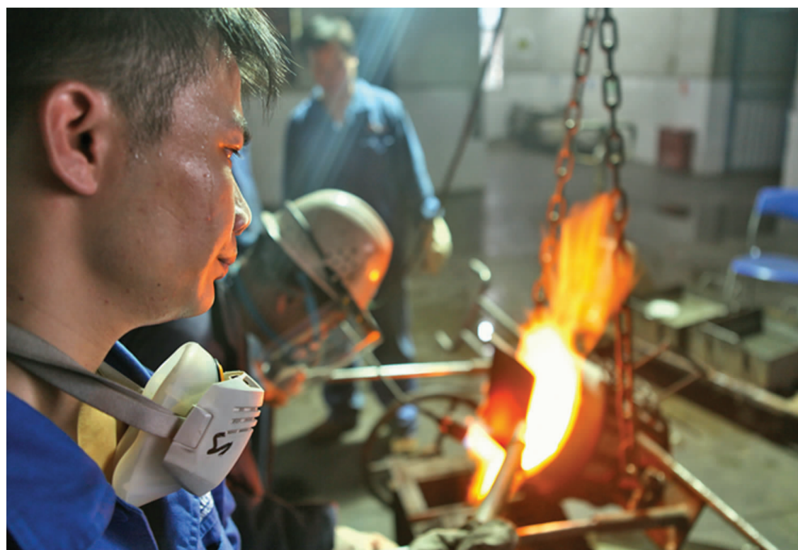
稀贵厂精炼车间浇铸厂房内“温情似火”,职工在高温工作环境中浇铸金锭、银锭。(叶志海 摄)
