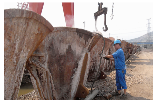
在渣冷现场,操作工正在将掉下的喷水皮管重新捡起,放入转渣包保证冷却效果。(王建华 摄)
