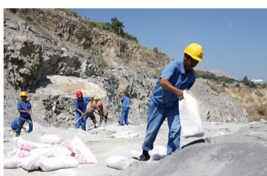
铜山口矿露天采车间加快采场生产平台的调整,爆破工顶烈日装填炸药进行爆破作业。(胡少俊 摄)
