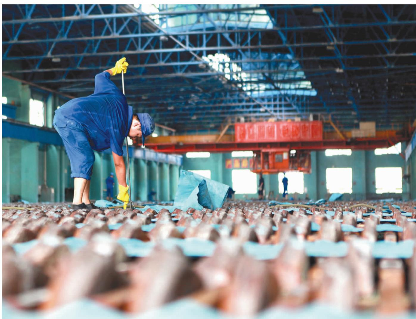
近日来,持续高温酷暑,冶炼厂在进行生产的同时,周密部署防暑降温工作,确保生产经营顺利进行。图为7月30日正午,该厂电二车间职工张亮在槽面上进行阴阳极校正。(刘飞 摄)
