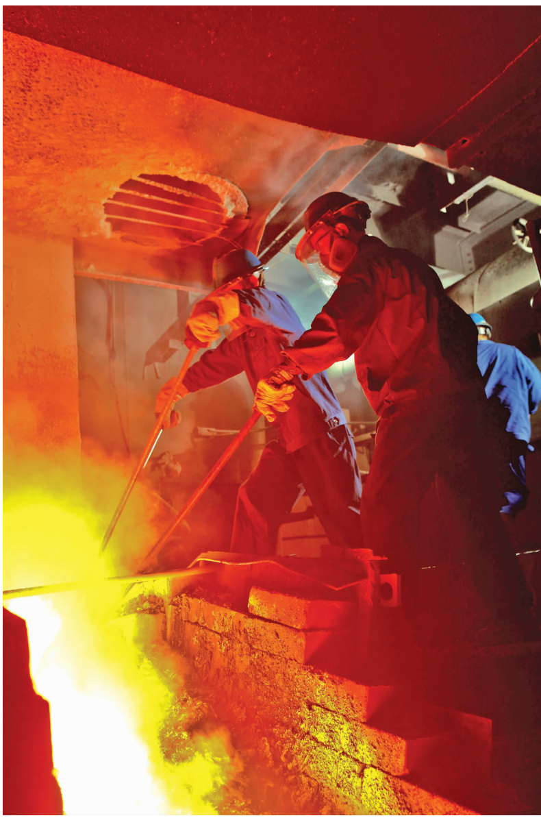
▲ 图为该工段两名职工正在利用木炭除焦法除焦。(刘飞摄)
