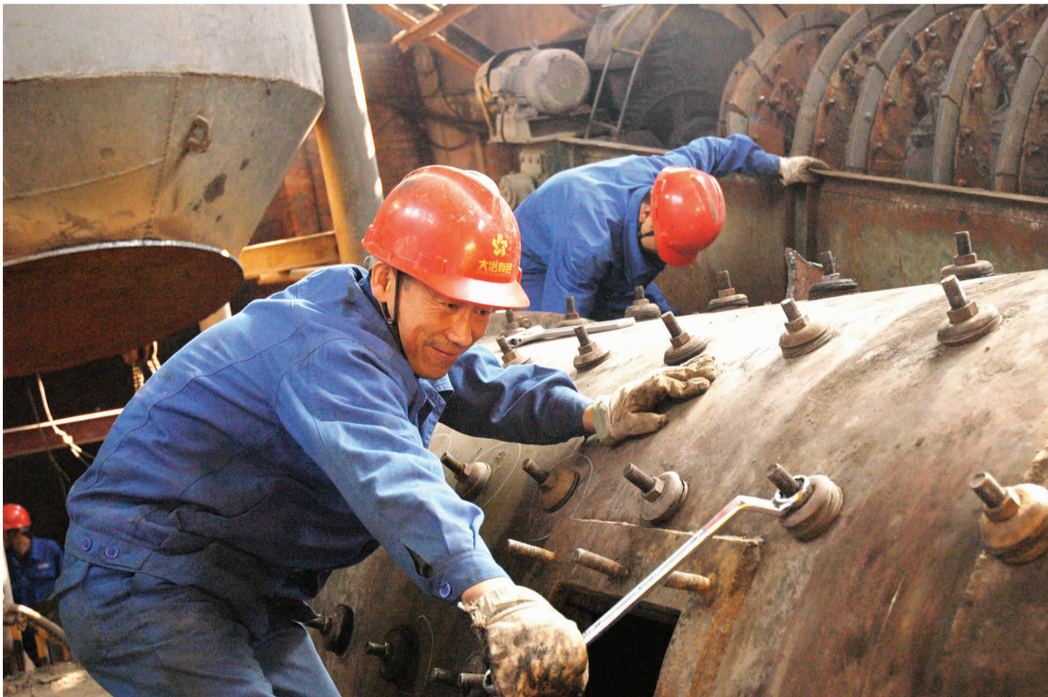
铜绿山矿三友公司推行设备“零故障”管理考核制度,要求维修工与操作人员共同承担设备保养的责任,从而改变以往操作人员只管生产效益,而忽视设备保养的不良现象。图为2月2日,该车间一浮选工正在检修球磨设备螺丝。(周志刚 摄)
