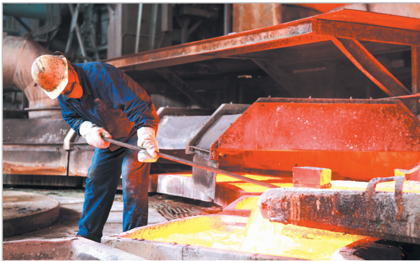
11月以来,冶炼厂转炉车间开展了“奋战60天,打好收官战”的劳动竞赛,广大干部职工鼓足干劲,紧盯奋战竞赛目标,在抢抓时效上下功夫,在增产增效上想点子,在节能降耗上做文章,在安全环保上见行动,全面掀起奋战热潮。图为11月3日,该车间正在精炼炉双圆盘浇铸作业。(张娟 摄)
