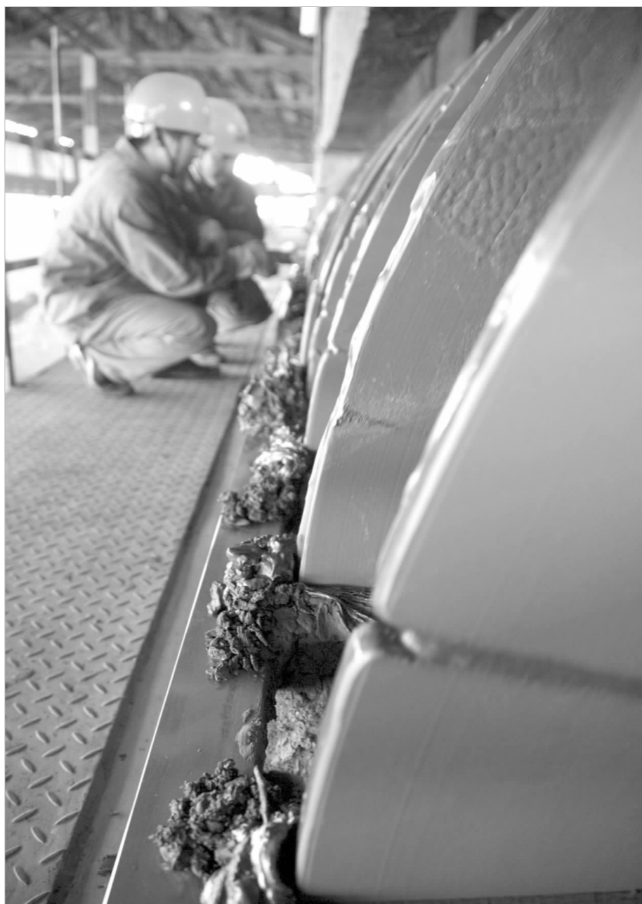
10月17日,两名职工熟练地运用手捻、目测监控铜精矿水份。今年以来,受矿石性质因素影响,铜绿山矿铜精矿水份居高不下。该矿在实施降低陶氏过滤器液位,增加干燥区面等一系列技改措施的基础上,通过加强职工培训力度,建立水份考核机制与职工的收入绩效挂钩等方式,操作工责任意识、技术水平大幅提高,铜精矿水份得到有效降低。9月份铜精矿含水率为15.3%,比照计划降低0.2个百分点。(秦霄 向锦辉 摄)
