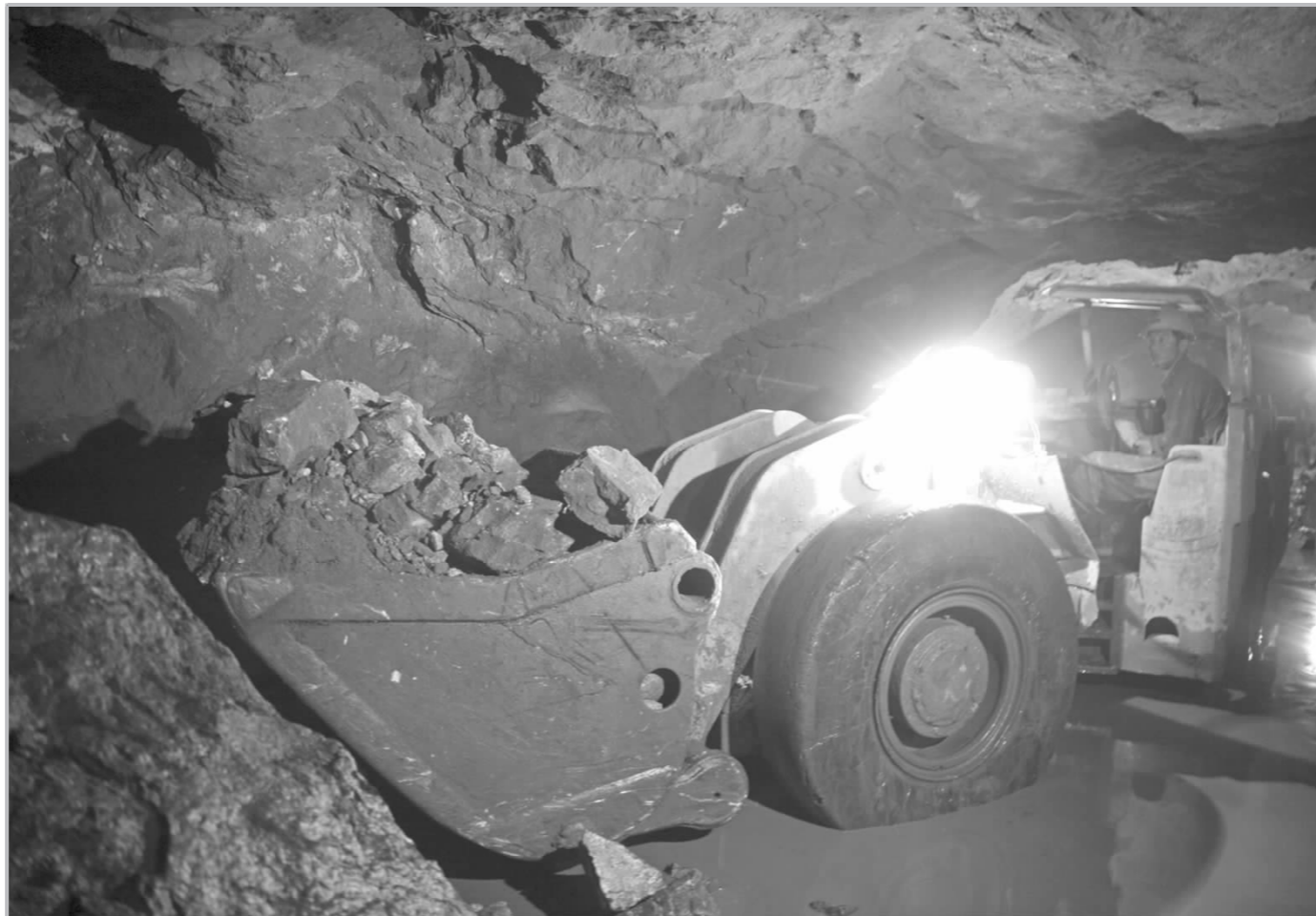
国庆节7天长假期间,铜绿山矿合理安排作业人员,实现矿山铜产量210吨,超出计划14吨,生产呈现火热势头。图为10月7日,该矿一名职工在井下负425米采场精心操纵铲运机出矿。(秦霄 高元兵 摄)
