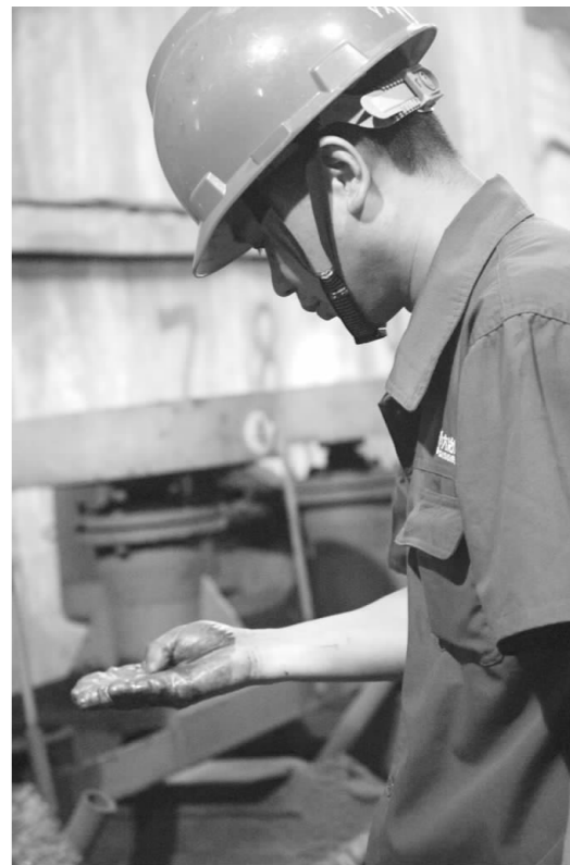
铜绿山矿三友公司加强技术改造,将以往的旧衬板换成新衬板,并采取调整排放口、勤换筛网等措施,确保流程畅通,保证矿石粒度,实现了“多碎少磨”的要求。图为浮选工汪红兵正在目测技术改造后的浮选槽精矿品位。(周志刚 摄)
