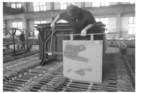
冶炼厂电二车间通过加强自主管理,严格产品过程控制,确保全年生产任务的完成。图为车间职工在进行始极片平整工作。(廖玉萍 刘建军 摄)
