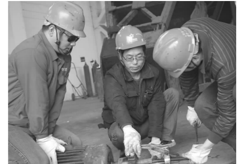
三友机制分公司大力开展技术练兵活动,以使维修人员从理论上吃透,从技术上“玩转”,力争不因同一原因而返工维修。图为该工段的技术人员正在精细拆除电机上的对轮。(周志刚 摄)
