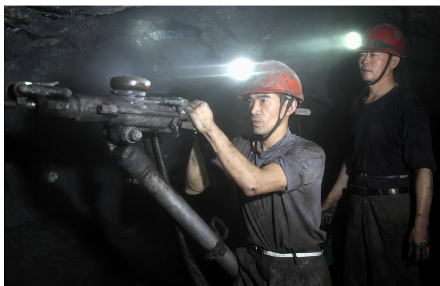
铜绿山矿三友公司采矿队积极开展“先帮后,老带新”的活动,由先进井下采矿的熟练人员帮助后来者,由技术操作水平较高的老师傅插入各班组,边干活边教新工人。图为老风钻工在向新工人传授凿岩安全操作技术。(周志刚摄)
