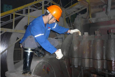
10月4日，铜绿山矿机运工段一名职工正在对老虎口连杆瓦进行加固。（陶坤 摄）
