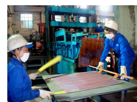
▲ 9月21日,电一车间一二系新钉耳机组正式投入生产。新上线的钉耳机组能大幅降低职工的劳动强度。单独的工作间,也能改善职工的工作环境。(张玲 摄)
