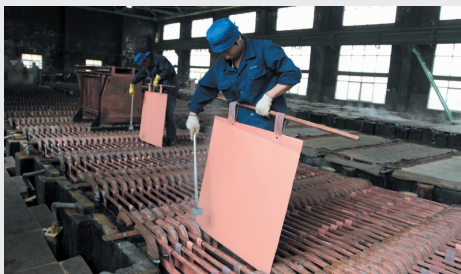
进入5月份后,电解一车间开展“自主管理、精细化管理”活动,将电解槽质量安全承包到个人,进一步强化职工的责任意识。图为职工正在检查阴极铜的生长情况。(张玲 摄)
