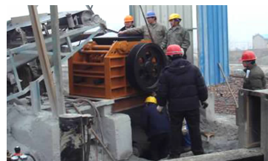
1月16日,铜山口矿劳动服务公司选矿厂Ⅱ次破碎进行改造,将原来的细碎颚式破碎改为双轮回转破碎,减小了矿石破碎的粒度,促进了球磨系统的高效运转,提高了原矿日处理量。(杜爱兵 摄)
