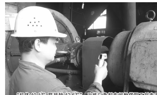
“机体40.1℃,联接处42.6℃”。冶炼厂备料车间粉煤职工刘赤手持红外线测温仪不到10秒钟就测出风机的“体温”。这是该厂最近给生产班组购买的高科技设备检测仪器,改变了过去依靠温度计测量设备温度的状况,提高了日常设备点巡检的质量和效率。
