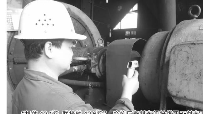
“机体40.1℃,联接处42.6℃”。冶炼厂备料车间粉煤职工刘赤手持红外线测温仪不到10秒钟就测出风机的“体温”。这是该厂最近给生产班组购买的高科技设备检测仪器,改变了过去依靠温度计测量设备温度的状况,提高了日常设备点巡检的质量和效率。
