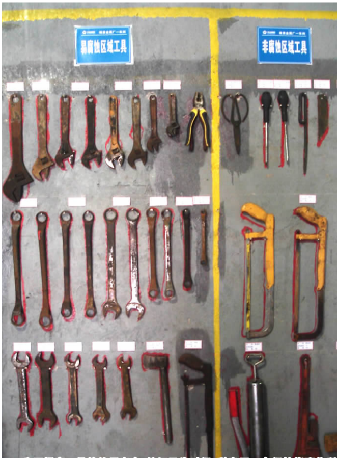
为了提高工具的使用寿命、缩短寻找时间,稀贵厂一车间焙烧班将所有工具画形悬挂,并根据其使用场所的环境分为易腐蚀性工具区和非腐蚀性工具区。(易理锡摄)
