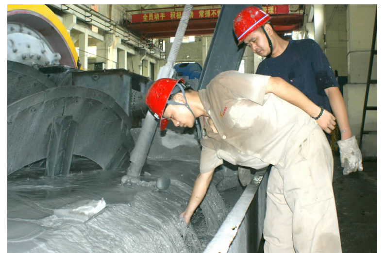
丰山铜矿上半年累计完成铜含量为年计划的54.24%;铜综合回收率达到90.78%,铜精矿品位达到21.38%,圆满实现时间过半、任务过半的生产经营目标。目前,该公司全面掀起夺高产热潮。图为生产一线员工冒着高温酷暑检查浮选机精矿浓度。(何永进 摄)
