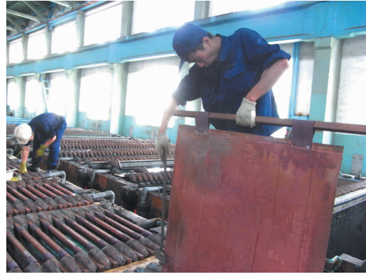
7月21日9时,60多℃的厂房内,冶炼厂电二车间大板电解槽上一职工正在整理阴极板。(柯昌军 摄)
