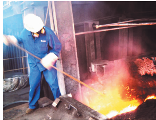
7月21日10:30,冶炼厂熔炼车间职工正在进行炉前放渣作业,现场温度高达60℃。(范丽霞 摄)
