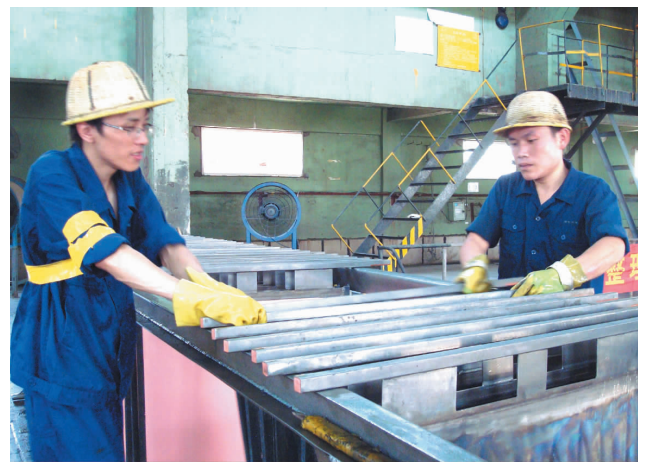
7月21日9:40,60℃的冶炼厂电解种板槽面现场,两名剥片工正将生产出来的始极片从钛板上剥下来。(刘飞 摄)
