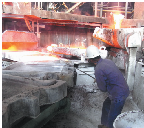
7月21日11时,冶炼厂转炉车间精炼炉浇铸机旁一职工正在200℃的溜槽口旁捅溜槽口。(柯昌军 摄)
