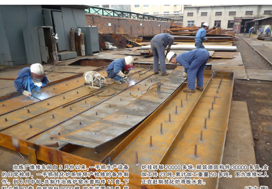
冶炼厂维修车间自5月份以来,一手抓生产设备的日常检修,一手抓贫化炉系统停产检修的备件制作。到6月中旬,共制作冶炼炉管水套构件11套、下料斗管60套、炉管钢钎9000根、灰灰装置54套、筑炉挂砖板20000多块、砌筑顶构件30000多具、金加工件23吨,累计加工重量50多吨。图为维修工人正在赶制贫化炉滑板水套。(伟力 摄)
