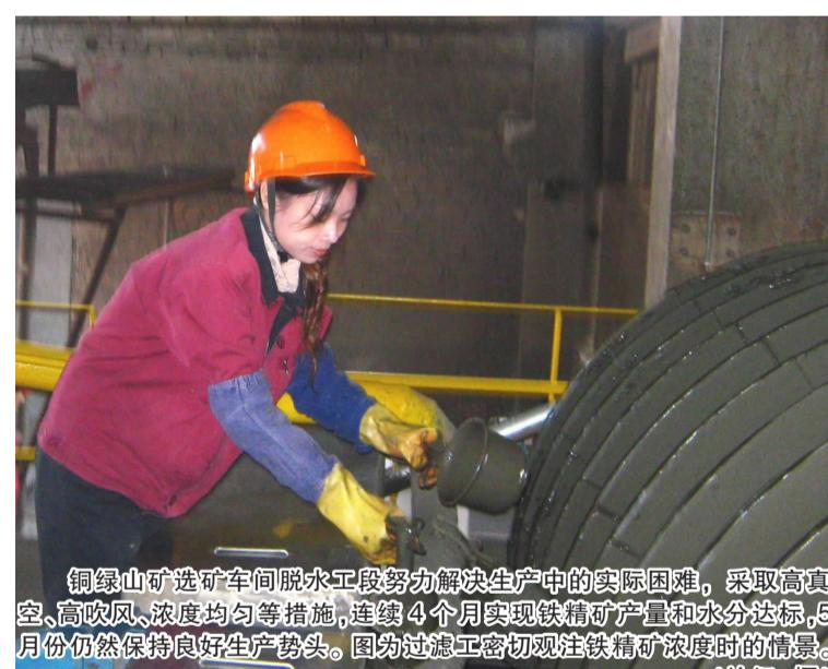
铜绿山矿选矿车间脱水工段努力解决生产中的实际困难,采取高真空、高吹风、浓度均匀等措施,连续4个月实现铁精矿产量和水分达标,5月份仍然保持良好生产势头。图为过滤工密切观察铁精矿浓度的情景。(於红 摄)
