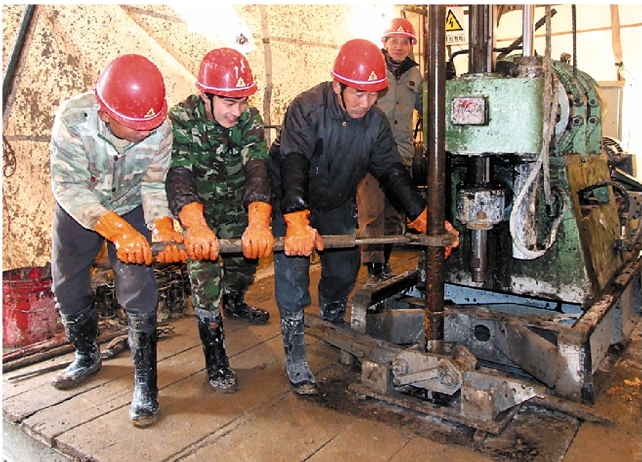
新年伊始,铜绿山矿加大了周边的探矿力度。据了解,由于露天采矿能力的逐渐消退,该矿努力寻找接替资源,破解企业发展瓶颈。图为该矿勘探人员在取样。(郭小勇 摄)
