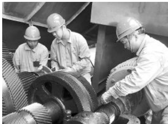
▲工程公司铆焊车间员工正在对4号熟料窑减速机进行解体大修。
