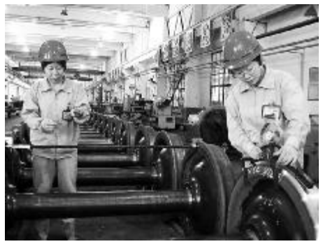
近期,面对大量自备矿石翻斗车和氧化铝罐车段检修定检集中到期的紧张局面,运输车队段员工攻坚克难,全力以赴做好车辆检修工作,确保每天3台罐车和1台翻斗车的检修。在满足正常生产需求的情况下,该部组织员工对车辆有顺序、有计划地进行检修。因为该部车辆段轮轴班员工在精心检修车辆轮轴。
