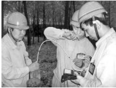
日前,河南分公司尾矿库安全标准化创建工作拉开序幕。本次创建为期8个月,共分为规划、实施、监督评价等6个阶段。图为员工正在冒雨测量坝体浸润线,严密监视地下水位升降情况。肖明 摄影报道
