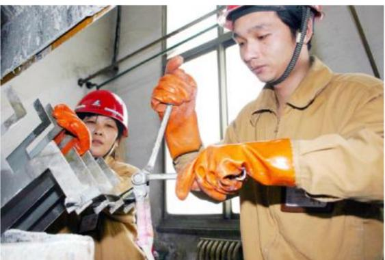
4月9日,氧化铝一厂熔车间电解工袁忠叙(右)格外高兴,他仅用5分钟就消除了1号电解槽母线松动导致垫片发热的事故隐患。
