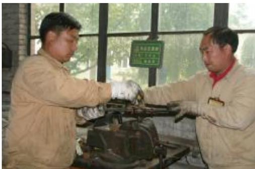
运输部工段认真贯彻执行分公司和运输部“挖潜增效”工作部署,积极开展修旧利废活动。11月10日,该段工业站工区员工把铁路维修后回收的300条鱼尾螺栓进行了除锈、涂油、套丝修复再利用,节约费用数千元。 欧阳建设 摄影报道
