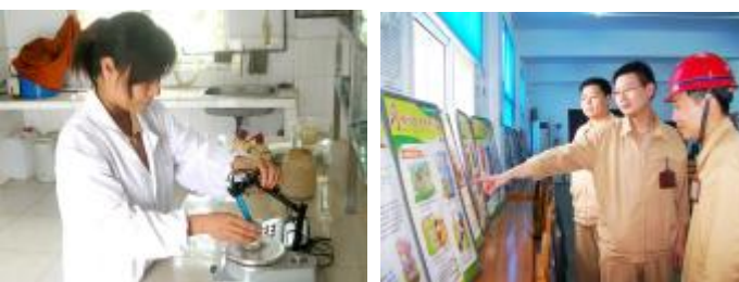
随着汛期的来临,为确保生产污水的重复利用和零排放,水电厂排水车间化验室加强了药品质量控制和水质监测力度,水电厂水质化验室正在检测水样的PH值。 康宏伟 奚溪 摄影报道
