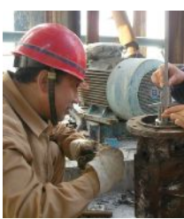
最近,氧化铝厂一八车间员工认真调试平盘过滤器流液泵的密封,确保流液泵不再冒料,促进了节能减排。 王丽娜 摄影报道
