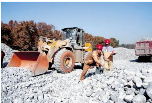
12:00 氧化铝厂矿石管理组员工正在对石灰石进行取样。为实现源头降本,氧化铝厂成立矿石管理组专门对矿石、煤、液碱等原燃材料进行现场把关。
